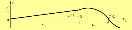
跳跃者以自由落体运动末速度  $v_F = \sqrt{2gL} = 30$  m/s 进入固有频率  $\omega = \sqrt{2}$  /s 和周期  $T = \sqrt{2\pi}$  s 的简谐运动.
